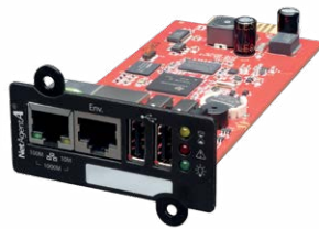
Карта SNMP с подключением датчика окружающей среды
